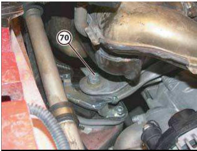
● 松开将发动机紧固至车辆底盘的两个螺钉 (70)。
