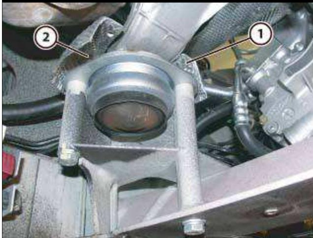
■ 通过从上方手动拧紧四个螺钉 (2) 安装两块隔热板 (1)。
