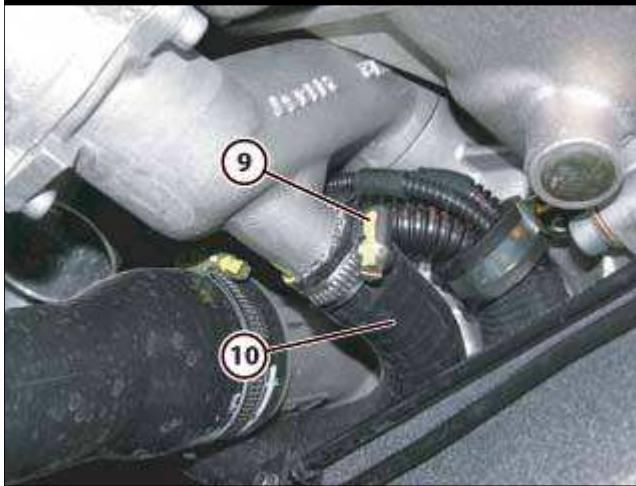
● 拆下夹箍 (9) 并断开冷却液管 (10)。
