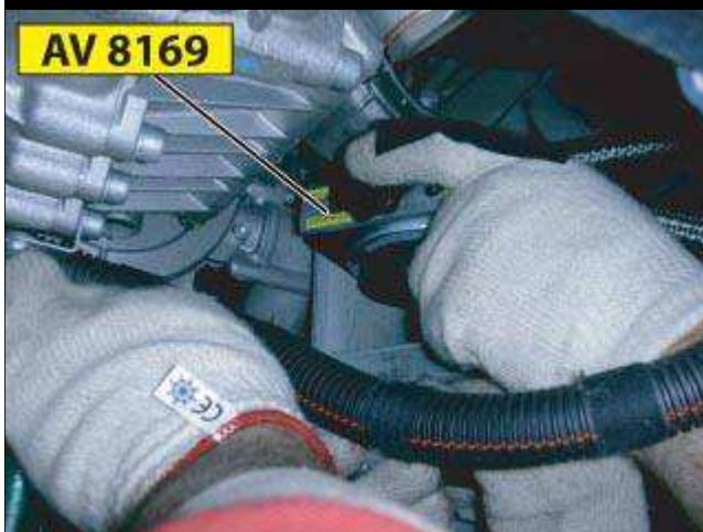
● 从发动机下方开始作业，使用工具 (AV 8169) 将橡胶衬垫对准底盘。
