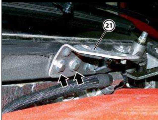
● 松开指示的螺钉，拆卸中央挡风玻璃下部护罩固定支架 (21)。
