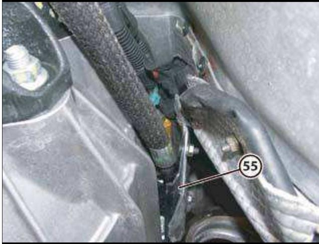
通过拧下离合器壳体上的两个螺母，将隔热罩 (55) 连同支架一起拆下。
