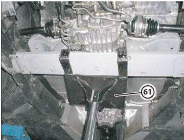
■ 将液压千斤顶 (61) 置于变速箱下, 缓慢升起直至与变速箱接触。
