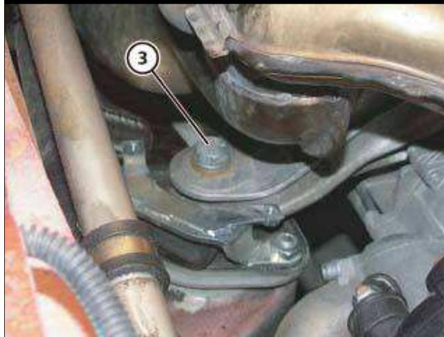
松开将发动机安装柱紧固至发动机橡胶衬套的两个螺钉 (3)。
