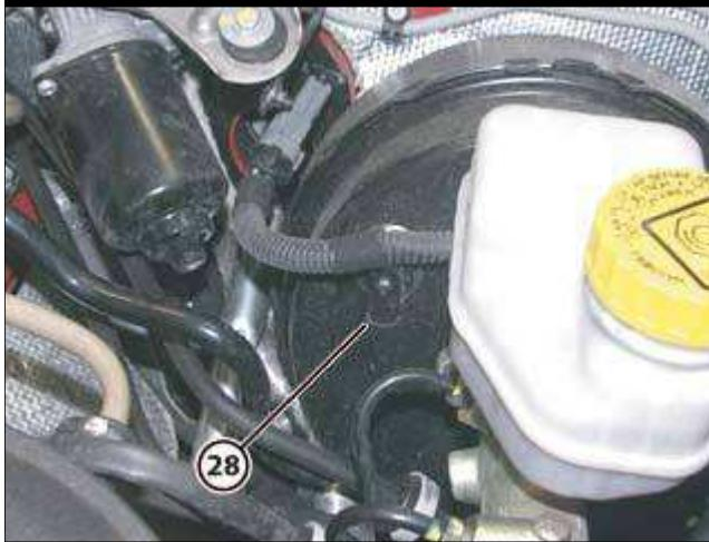
● 断开制动伺服装置上的管 (28)。
