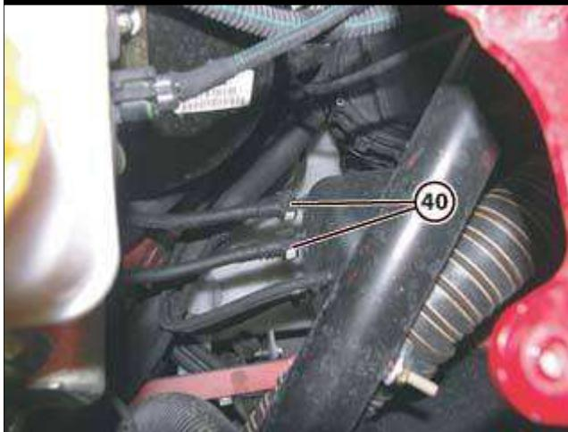
● 断开通至储压罐的连接管上的两个快速接头 (40)。
