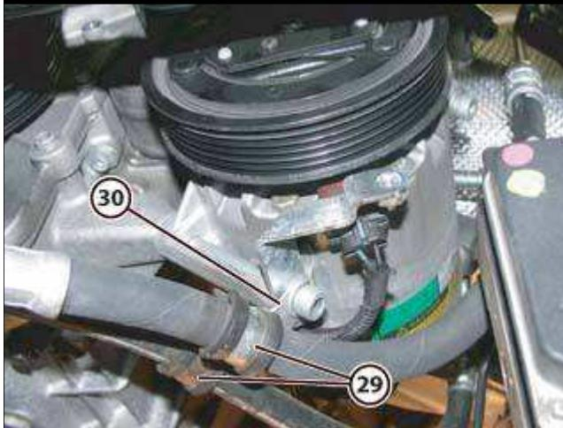
● 从固定支架 (30) 拆卸两个夹箍 (29)，松开两根管子。
